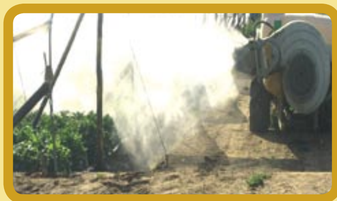
FIGURA 1: FUNGICIDI DISTRIBUITI CON UN'UNICA APPLICAZIONE CON IRRORATRICE DEL TIPO AD AEROCONVEZIONE
